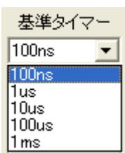
内部基準パルスの時間を設定します。内部カウンタはこの時間間隔でカウントアップし、外部パルス入力の検出でカウント数を記録します。タイマーの時間分解能になります。
