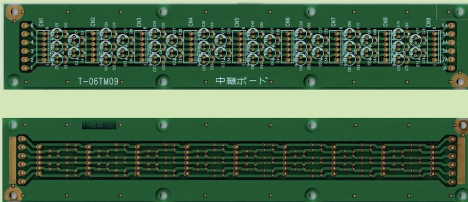
大きさ:40×220 固定穴:φ3.2×8か所 固定穴ピッチ:33×210 他 各mm
