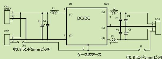
基板寸法:74×43×1.6mm 取付穴:φ3.2×6 取付穴ピッチ33×39及び54mm
