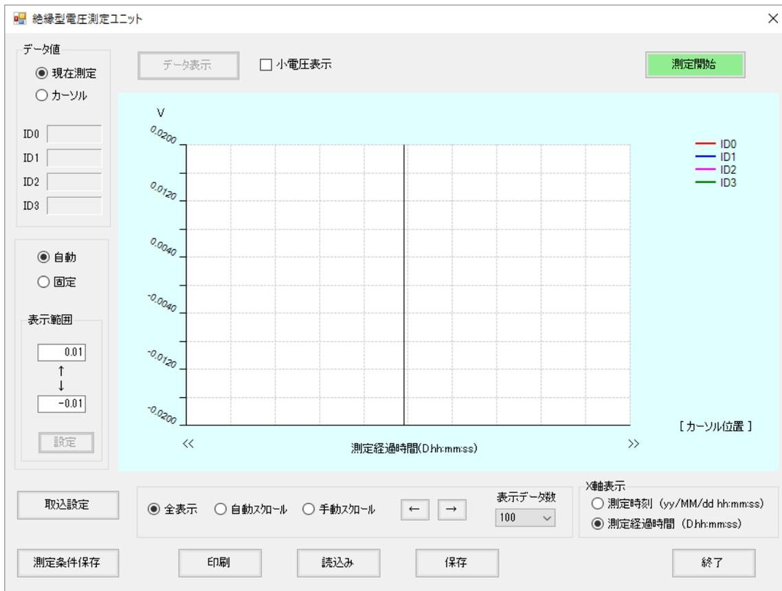
「取込設定」ボタンにより取込条件の設定を行い、開始ボタンにより測定を開始します。測定中はグラフでデータを確認できます。
