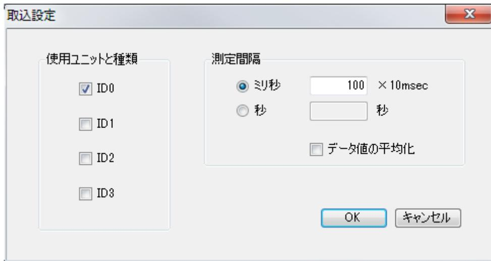
取込条件を設定します。取込を行うユニットの ID や取込間隔を設定します。
