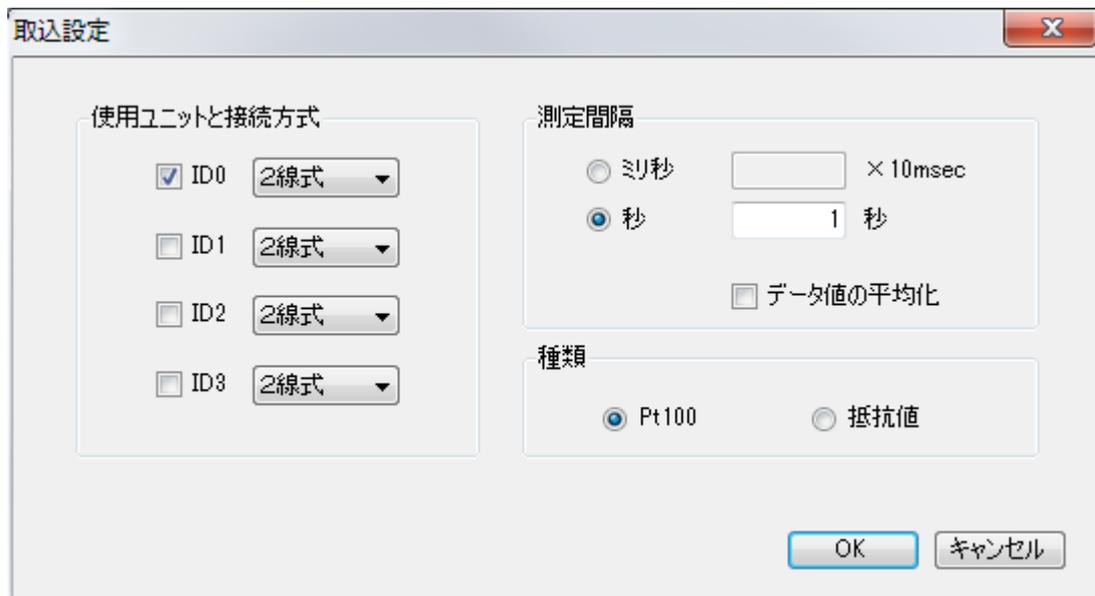
取込条件を設定します。取込を行うユニットの ID や取込間隔、取込データの種類を選択します。
