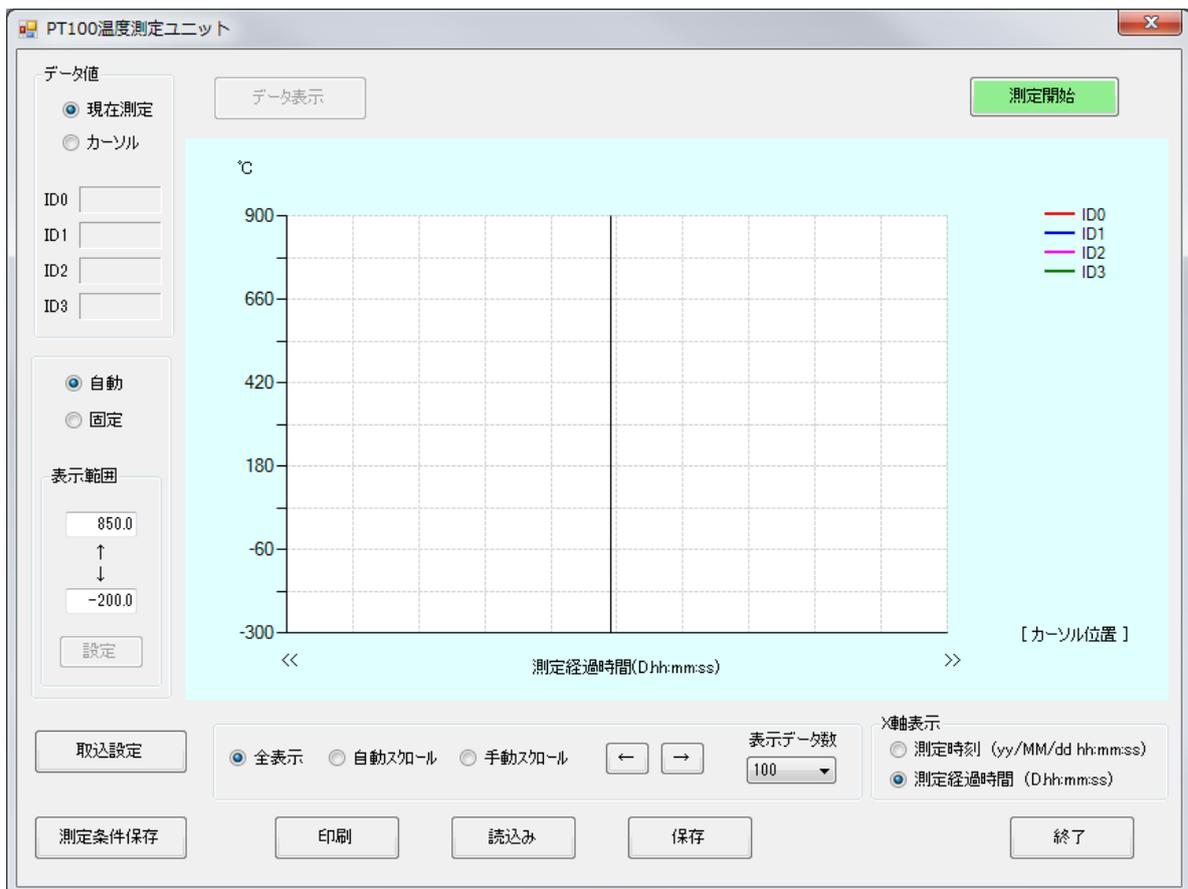
「取込設定」ボタンにより取込条件の設定を行い、開始ボタンにより測定を開始します。
