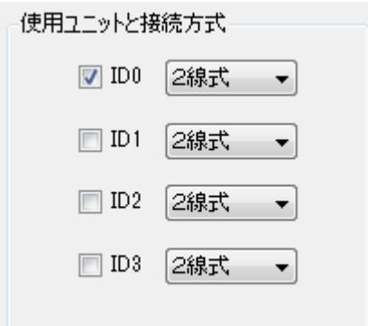
使用する ID に設定したユニット(TUSB-S01PT)をチェックしてください。使用するユニットの接続方式はその右側にあるリストから選択してください。(2,3,4 線式)
